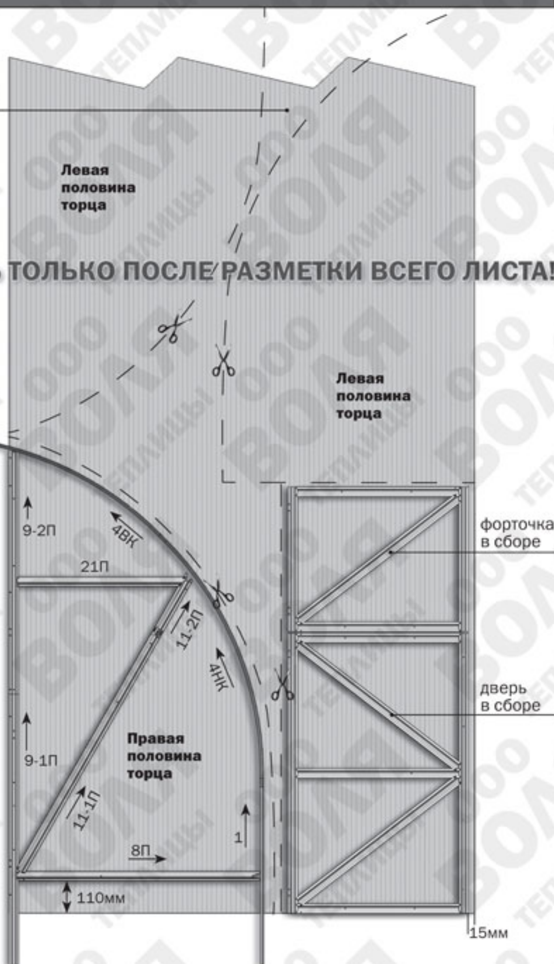
Рис. 4 Расположение деталей при раскрое.
